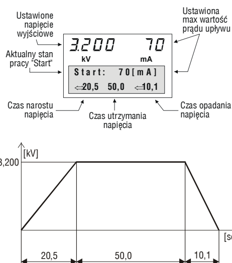
Rys.1. Ustawienia systemu sterująco-pomiarowego i wykres ilustrujący przebieg próby wg tych ustawień
